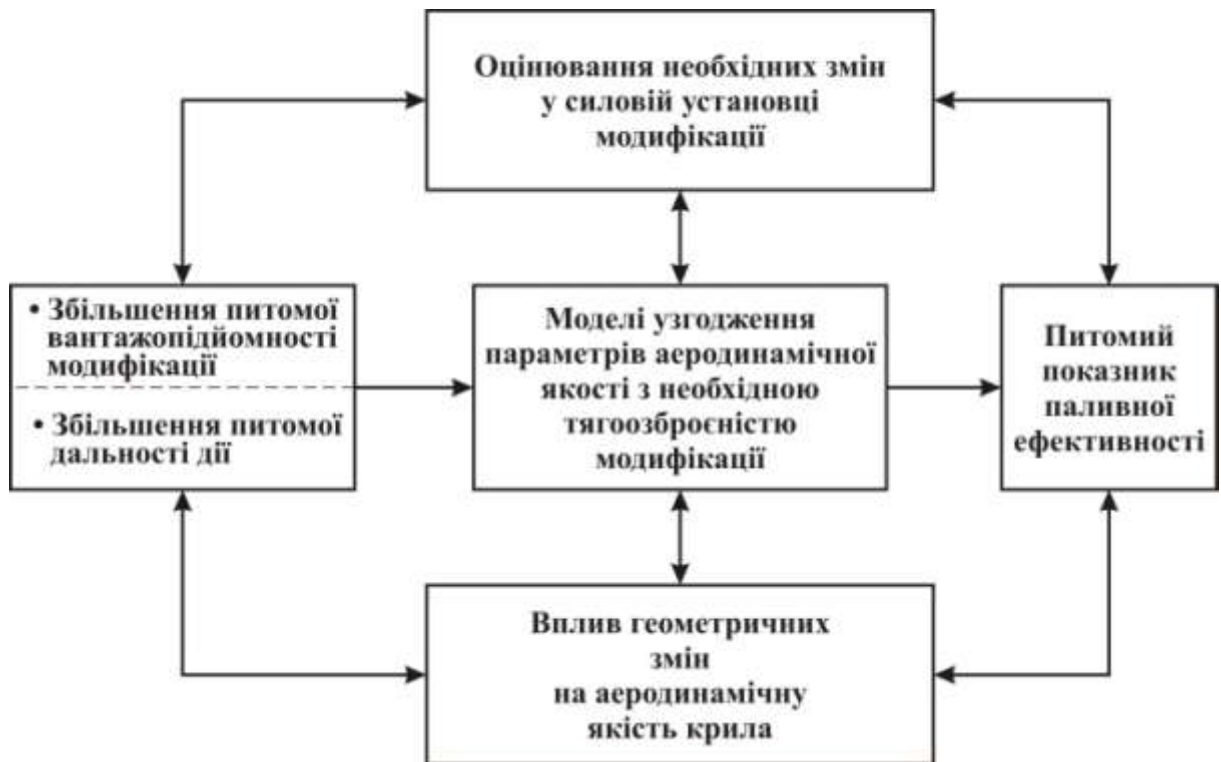
Рисунок 10 – Схема узгодження глибоких змін в геометрії крила і силовій установці на етапі попереднього проектування модифікацій
